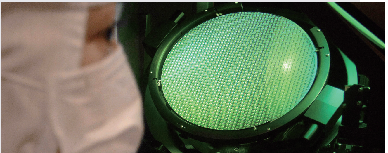
集積回路の製造に使われる12インチのウェハーをチェックするエンジニア(Credit: Sam Yeh / Staff, Getty Images)
