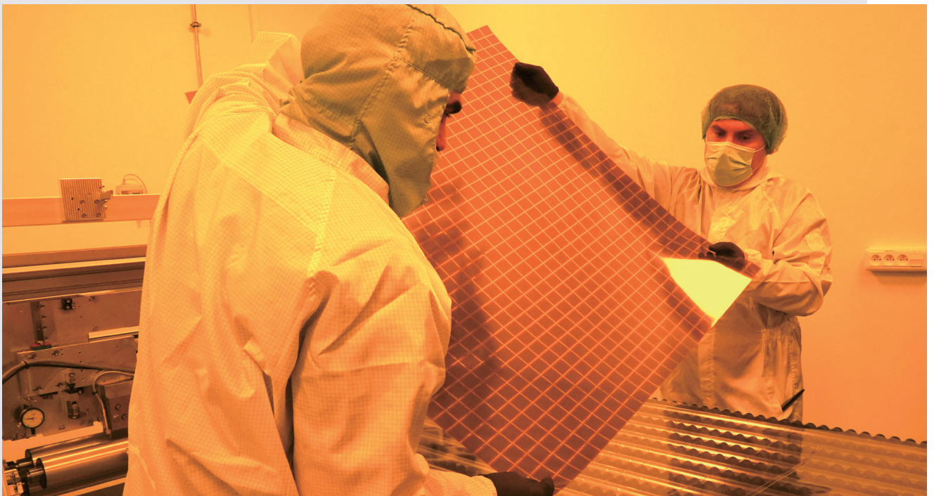
画期的なペロブスカイト技術で製造されたソーラーパネル(Credit: Bjanek Skarzynski / Contributor, Getty Images)
